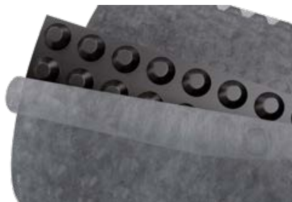
Двухслойные композитные мембраны (дренажное ядро из жесткого полимера HDPE + фильтр из нетканого геотекстильного материала)
