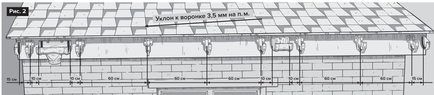
4. Закрепите воронку через специальные отверстия в запланированном месте ниже уровня первого кронштейна с учетом рассчитанного ранее наклона желоба (см. п. 3). Воронка имеет 2 крепёжных ответвуха и монтируется к лобовой доске саморезами 5×30 мм.
