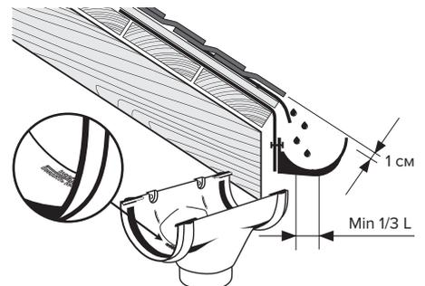
**! Невыполнение данных условий приводит к риску повреждения желобов при лавинообразном сходе снега с кровли.**
