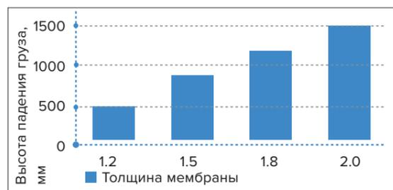
Рис. 4.3.2 Зависимость показателя ударной прочности от толщины мембраны
