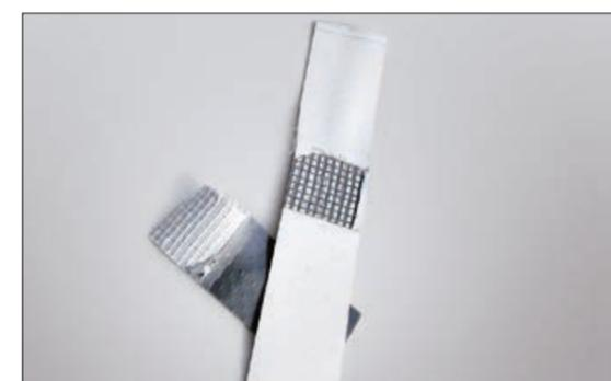
Рис. 5.2.10 Вырезание тестовой полоски из сварного шва
