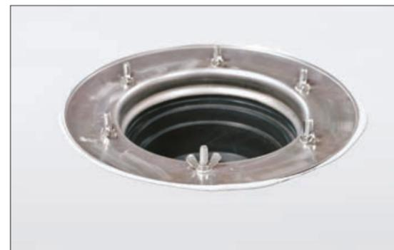
9. Прикрутите фланец гайками. Желательно получить выдавливание небольшого количества герметика из-под фланца после закручивания всех гаек.
