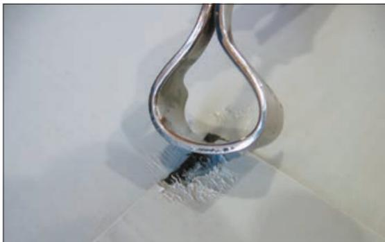
Рис. 5.2.14 Инструмент для подрезки нижнего полотнища мембраны
