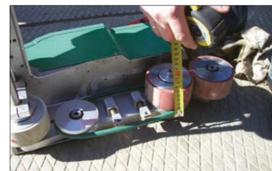
Рис. 3.5.5 Ширина рабочей поверхности Leister Varimat равная 60 мм
