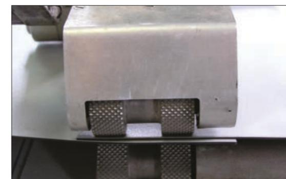
Рис. 5.2.11 Приводные ролики аппарата Twinny T
