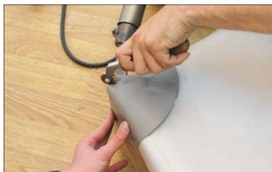
8. Заготовку укладываем на подходящий угол, например, стола и привариваем последовательно все стыки, начиная от отрезанной полосы.
