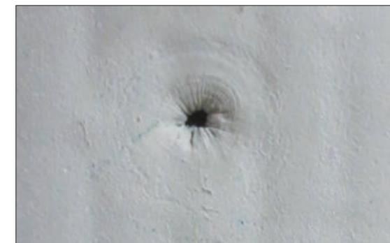
4.3.5 Повреждение на образце мембраны после испытания
