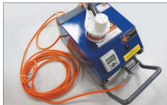
Рис. 2.3.2 Аппарат для индукционной сварки
