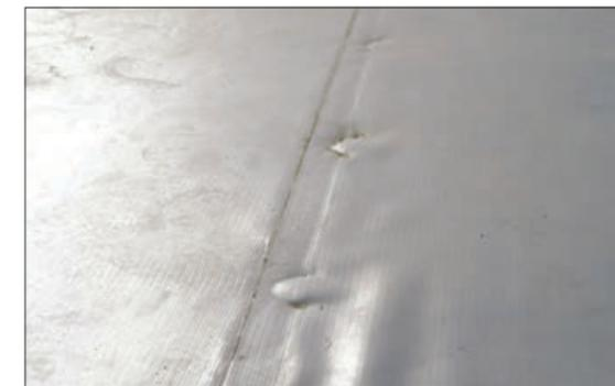
Рис. 3.5.7 Дефект сварного шва
