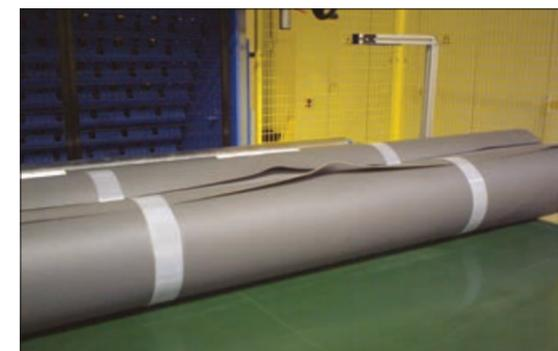
Рис. 4.2.1 Рулоны полимерных мембран ТЕХНОНИКОЛЬ, зафиксированные полиэтиленовой лентой
